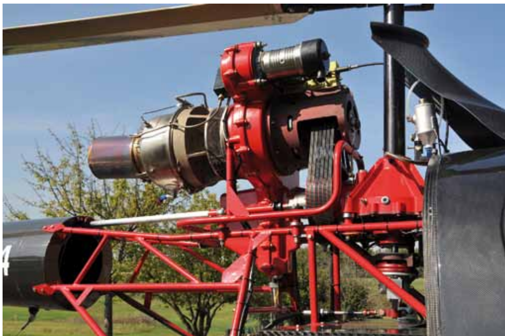
Turbine Solar T32 de 162 ch. Elle anime le Kiss 209M équipé d'un embrayage spécifiquement développé par Famà, ce qui permet d'ailleurs un démarrage très rapide de la turbine.
